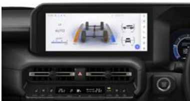
マルチテレインセレクト表示画面 (デフロックのオン/オフ状態を表示)
