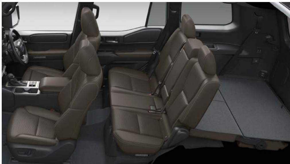
サードシート両側フロア格納状態
