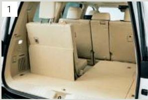
1 スwitchを押すとシートバックが自動で格納開始。
