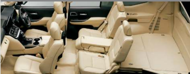
セカンドシート中央前倒し+サードシート両側フロア格納状態
