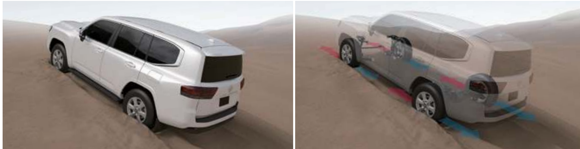
クローラコントロールシステムイメージ(スタック状態からの後退脱出)
