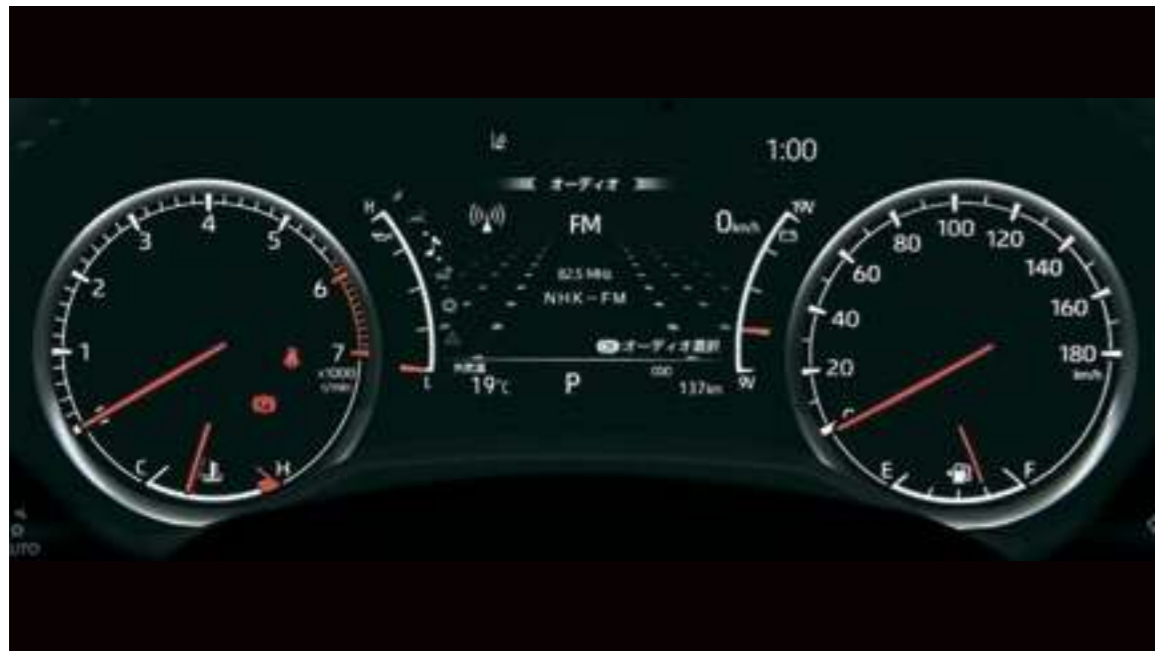
2眼オプティロンメーター+7インチTFTカラーマルチインフォメーションディスプレイ
