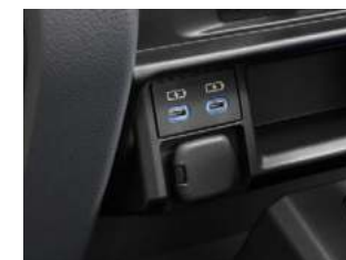
②充電用USB端子(Type-C/フロント2個)/アクセサリソケット(DC12V・120W/1個)
