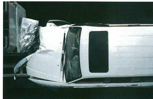
●衝突安全ボディ【GOA】 オフセット前面衝突実験(60km/h) (写真は実験用の試作車です。)
