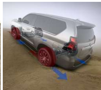
クロールコントロールシステム作動イメージ(スタック状態からの後退脱出)
