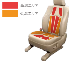
シートベンチレーション&快適温熱シートスイッチ (写真は快適温熱シート作動状態)
