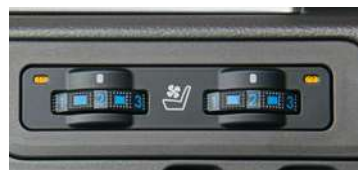
シートベンチレーション&快適温熱シートスイッチ (写真はシートベンチレーション作動状態)
