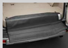
荷物積み降ろし時のバンパーの傷つきを防止
