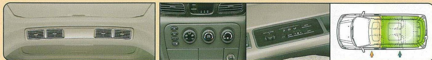
フルエアミックスデュアルオートエアコン(外気温計付) リングダイヤル式ヒーターコントロールパネル プッシュ式リヤヒーターコントロールパネル 前後独立温度・風量コントロール
