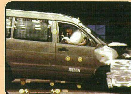
オフセット前面衝突実験 (64km/h) [写真は実験用の試作車です]
