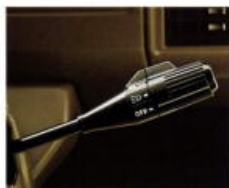
集中一体式スイッチ シートベルトを締めてからに手の届く位置にライト関係のスイッチを集中させました。軽い操作でライトの切り替えができます。
