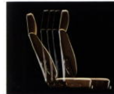
運転席リクライニングシート 4段階のリクライニング。シートスライド量は140mm。レッグスペースも広く、快適なドライブポジションがとれます。
