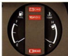
ウォーニング ブレーキ(オイル)量と車温、小用圧、バッテリー充電などの異常を瞬時のうちに警告。より高い安全のために、全車標準装備です。
