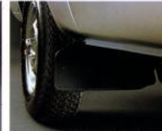
マッドガード タイヤがはねる泥や小石が、自車を汚したり、傷ついたりするのを防ぎます。全車、前輪に標準装備しました。スディルにも同梱です。
