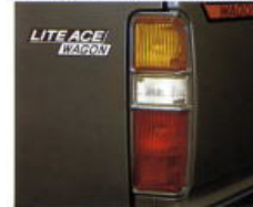
大型リヤコンビネーションランプ あらゆるケースでの安全対策を考慮して、サイドボディにまで3割込込んだ大型コンビネーションランプを全車に採用。
