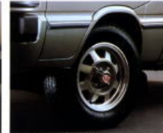
アルミホイール さすが、速いワゴンの名に恥じず、ついにアルミホイールもオプションとして初登場。185/70HR13ワイドラジアルタイヤとセットでGXLに。
