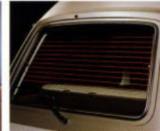
熱線式リヤウインドデフロガー デアウインドの曇りを一掃します。常に後方視界を確保するので安全です。XL以上に標準装備。DXにオプション。
