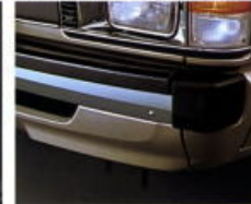
オーバーライダーつきバンパー フロント、リヤともにゴム製のオーバーライダーをXL, GXLに標準装備。小さな傷がバンパーを守るコーナークラークは全車標準。
