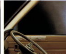
サイドデフロスター インパネ両側のサイドデフロスターが左右ドアガラスの曇りを一掃します。側方視界を常に確保するので安全。GXLに標準装備。
