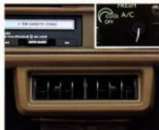
エアコン 除湿もできるオールシーズンタイプの専用カーエアコン。車内の温度が一定になるように3方吹き出し方式を採用。全車にオプション。
