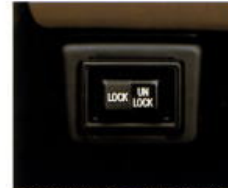
バックドア電磁ロック 運転席からバックドアのロックおよびアンロックができます。車の後方に回ってキレを使う必要がありません。DX以上にオプション。
