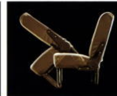
セカンドシートウォークイン機構 1人掛りのセカンドシートを前倒しにしました。ワンタッチで操作できるで後席への乗り降りがスムーズです。
