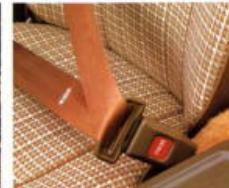
ELR式フロントシートベルト いざ、いざ時にだけロックするELR式をXL, GXLにオプション。ふだんは身体の動きにあわせて自由に伸び縮みします。
