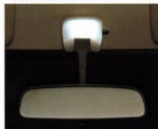
運転席ルームランプ バックミラーを組み合わせた一体式ルームランプを運転席に設置。光量は10Wで大きく、夜間作業に威力を発揮します。全車に標準装備。
