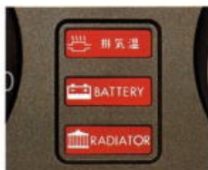
OKモニター バッテリー液量およびラジエーター液量の不足をチェックし、ドライバーに警告します。視認性が高く、安全です。X.L, GXLに標準装備。
