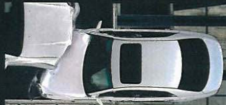
Car to Car SUV前衝突実験 (50km/h 写真は実験用の試作車です)
