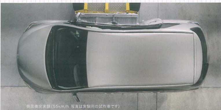
側面衝突実験(55km/h 写真は実験用の試作車です)
