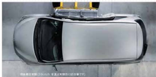
側面衝突試験 (55km/h: 写真は実乗用の試乗車です)
