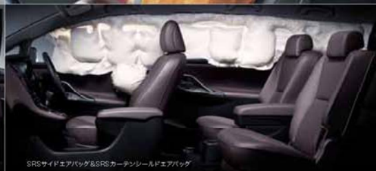
SRSサイドエアバッグ&SRSカーテンシールドエアバッグ
