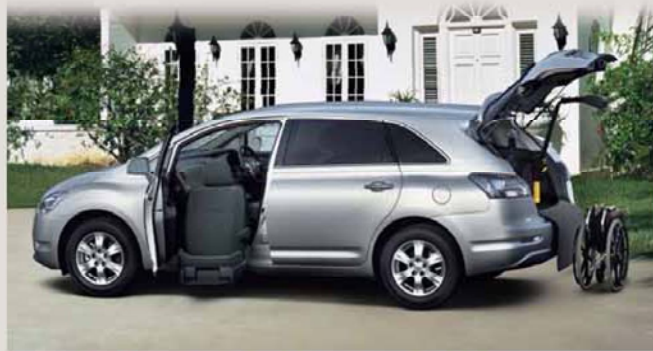
“Bタイプ” 助手席リフトアップシート+手動車いす用収納装置(電動式)
