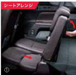
サードシート格納操作 ①シートバックのレバーを軽く引くと自動的にクッションが格納。②シートバックを前に倒す。
