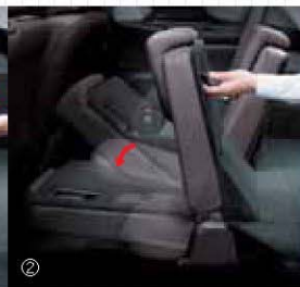
サードシート格納操作 ①シートバックのレバーを軽く引くと自動的にクッションが格納。②シートバックを前に倒す。
