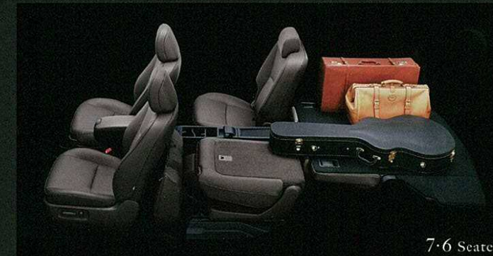
7-6 Seater サードシート両側+セカンドシート片側可倒状態
