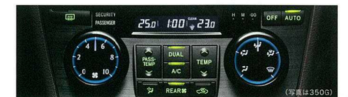
左右独立温度コントロールフルオートエアコン&オプティロンヒーターコントロールパネル(クリスタルシャイン方式)
