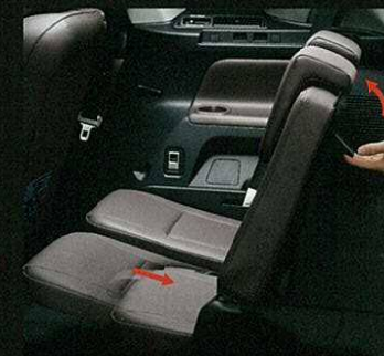
シートバックのレバーを引くと 連動してクッションが格納。
