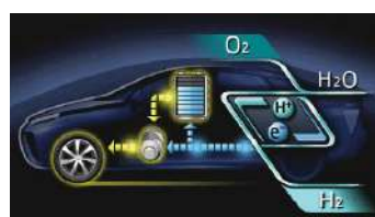
エネルギーモニター
