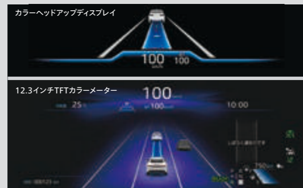
ブルー基調 (制御走行中: 条件が整いステアリングから手を放して走行できる状態) ※画面表示は先行車追従走行時
