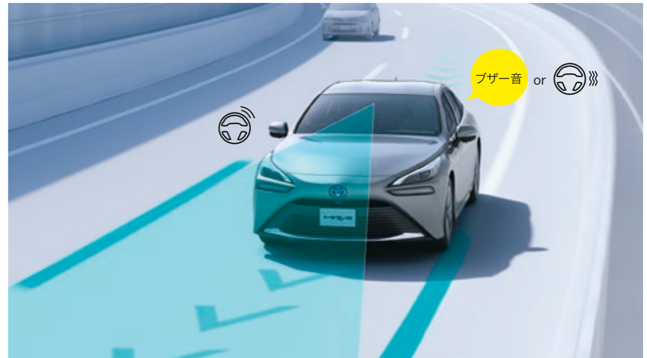
車線をはみ出しそうなときは、ブザーまたはステアリングの振動*2&ディスプレイ表示に加え、ステアリング操作の一部を支援。
