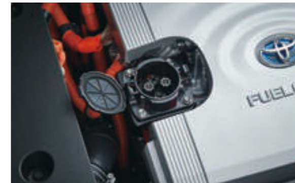
外部給電アウトレット (ボンネット下コンパートメント内)
