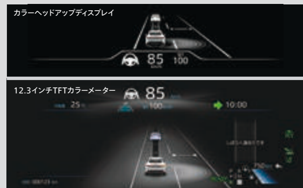
グレー基調 (制御走行中: ステアリング保持が必要な状態) ※画面表示は低速車追い越し時の車線変更前
