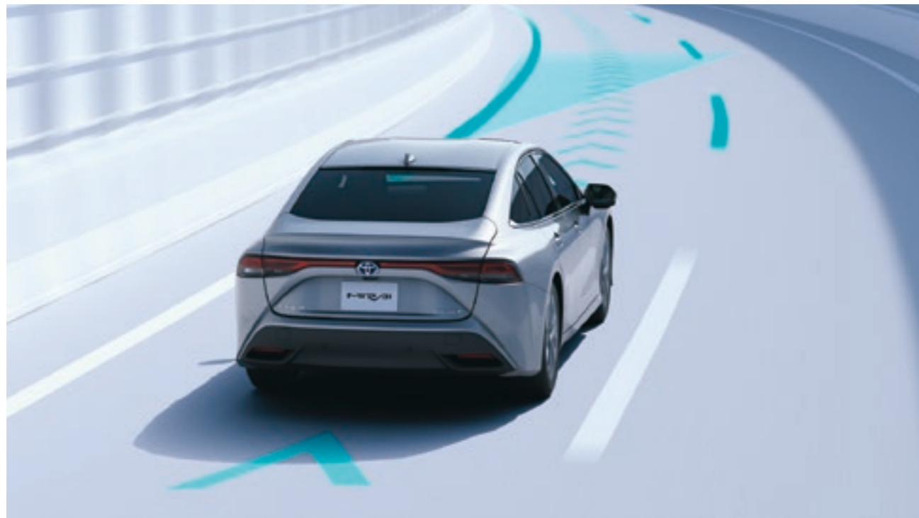
車線の中央を走行するために必要なステアリング操作の一部を支援*1。
