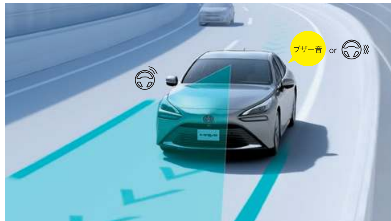
車線をはみ出しそうなときは、ブザーまたはステアリングの振動*2 & ディスプレイ表示に加え、ステアリング操作の一部を支援。
