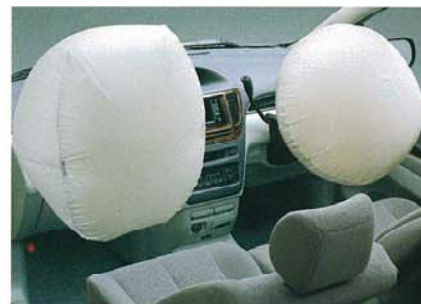
デュアルSRSエアバッグ(運転席・助手席SRSエアバッグ) *写真は撮影のため、SRSエアバッグが作動した状態をイメージしたものです。
