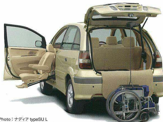
Photo: ナディア typeSU L 助手席リフトアップシート車 "Bタイプ" (TA-ACN10H-VTSHQYR)。ボディカラーはシャンパンメタリック<583>。 クリアランスソナー&バックソナーはメーカーオプション。移乗機構付車いすは架装メーカーオプション。
