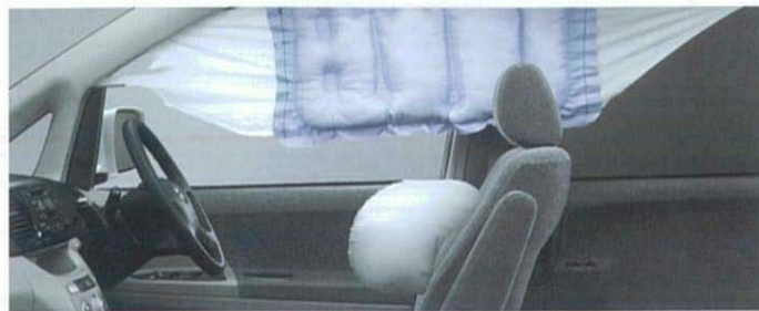
前席SRSサイドエアバッグ&SRSカーテンシールドエアバッグ
