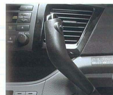
電子制御フレックスロックアップ付4速オートマチック シフトレバー (ガングリップタイプ/メッキボタン)
