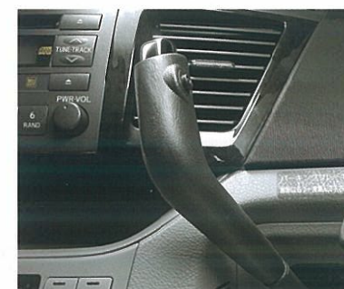
電子制御フレックスロックアップ付4速オートマチック シフトレバー (ガングリップタイプ/メッキボタン)
