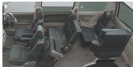
セカンドタンブル(左側)+サード(左側)スペースアップ状態
