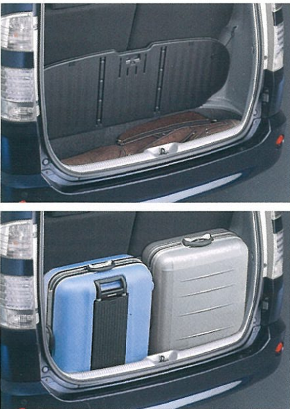
■写真は2WD車 スーパーラゲージボックス サードシートの後方を有効活用した大容量の床下収納スペース※。カバーを開ければ、高さのある荷物もラクに収納できます。また、サードシートをはね上げて、そのまま使用できます。 ※容量:77ℓ (2WD車)、46ℓ (4WD車) ※数値はVDA法によります。
