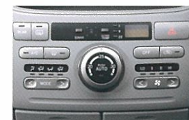
プッシュダイヤル式フロントコントロールパネル/デュアルオートエアコン (リヤクーラー付) & リヤコントロールパネル (ヒーター+クーラー用)
