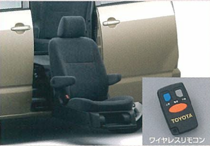
“サイドリフトアップシート装着車” セカンドシート左席に乗降をサポートするサイドリフトアップシートを装着しました。昇降スイッチまたはワイヤレスリモコンを押し続けることにより、シートをスライド・回転させた後、下降させる一連の動作を電動で行なえるシステムです。また、リクライニング・前後スライド調整も電動で操作することができます。 ※国や地方自治体では消費税の非課税等の助成措置が用意されています。詳しくは最寄りの福祉事務所・税務署・都道府県税事務所・警察署にお問い合わせください。 ※詳しくはワエルキャパカタログをご覧ください。
