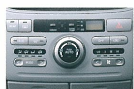
プッシュダイヤル式フロントコントロールパネル/デュアルオートエアコン (リヤクーラー付) & リヤコントロールパネル (ヒーター・クーラー用)
