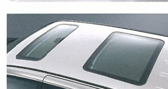
ツインムーンルーフ (サンシェード付・フロントチルト/リヤ電動スライド挟み込み防止機能付*)
