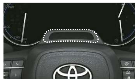
ドライバーモニターカメラ ■ドライバーモニターカメラで運転者の顔の位置・向きや眼の開閉状態を検知。運転者が周囲の状況を確認し運転操作できる状態であるかシステムが判断し、ブザーとディスプレイ表示で注意喚起を行います。 *3
