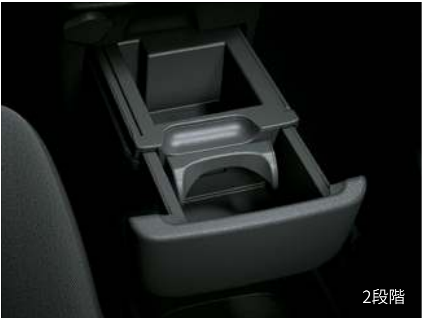
⑬2段階引出し式センターホルダー（カップホルダー1個・小物入れ・カードホルダー）＊2
