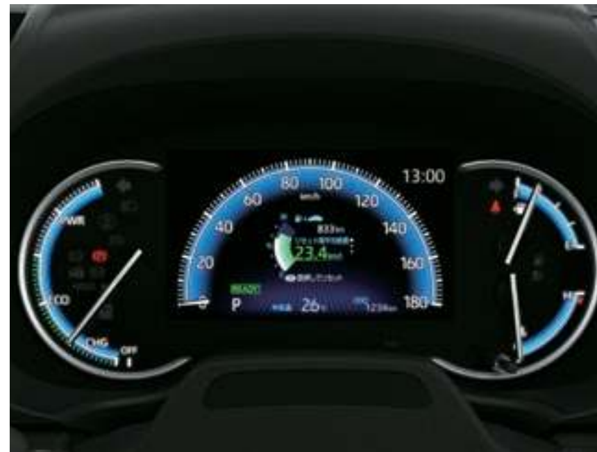
オプティロンメーター＋7.0インチTFT カラーマルチインフォメーションディスプレイ [S-Zに標準装備（写真はハイブリッド車）]
