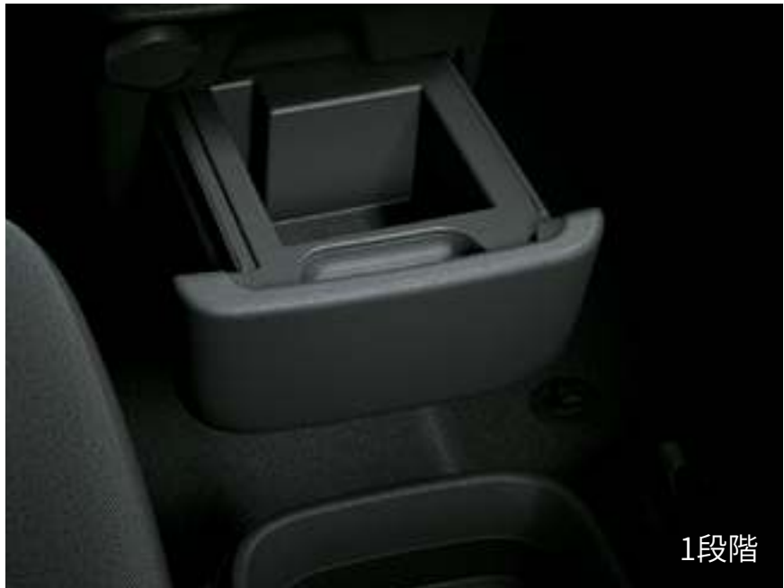
⑫2段階引出し式センターホルダー（カップホルダー1個・小物入れ・カードホルダー）＊2
