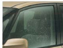
雨水機能付フロントドアガラス (グリーンUVカット) 雨天の高速走行時などに、ガラス面の雨滴を細かい粒子状にして排除し、視認性を向上させます。
