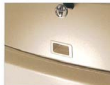
電気式バックドアアウトサイドハンドル バックドアハンドルに内蔵されているスイッチを軽く押すだけで、バックドアを開けることができます。
