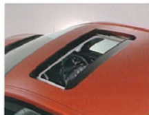
チルト&スライド電動ムーンルーフ (ワンタッチ式快み込み止め機能付) ムーンルーフのチルト&スライドがワンタッチ操作で行えます。
