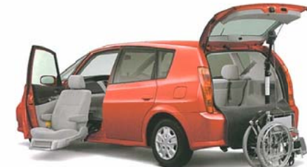
Photo:2WD 1.8 a"L package" 助手席リフトアップシート車"Bタイプ"。ボディカラーはレッドマイカメタリック(3N8)。写真の移乗機構付車いすは架装オプションです。
