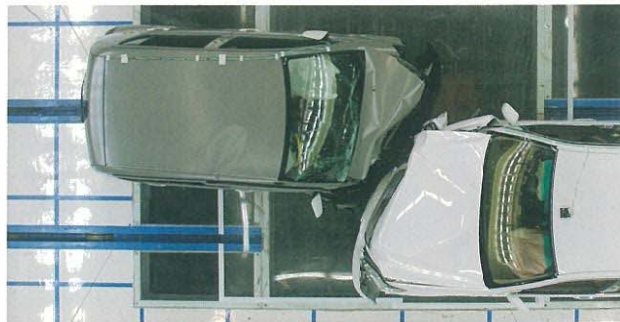
Car to car 50%ラップオフセット前面衝突実験 (50km/h) 写真は実験用の車両です
