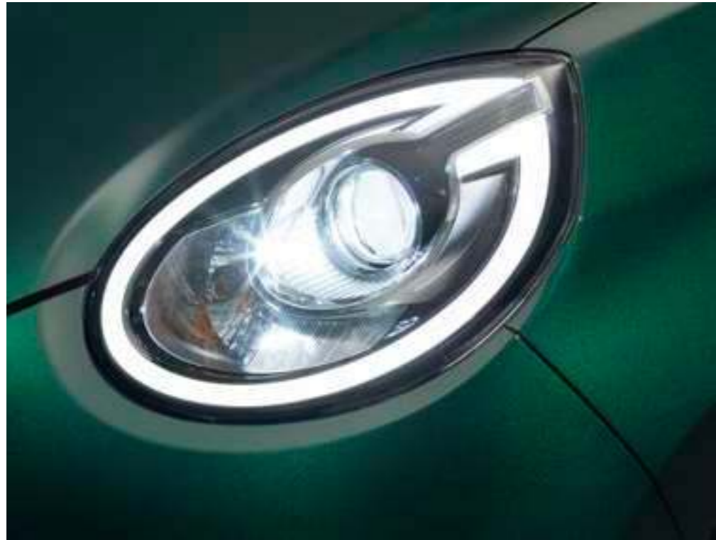
[A] Bi-Beam LEDヘッドランプ（ロー/ハイビーム・オートレベリング機能付）+LEDクリアランスランプ
