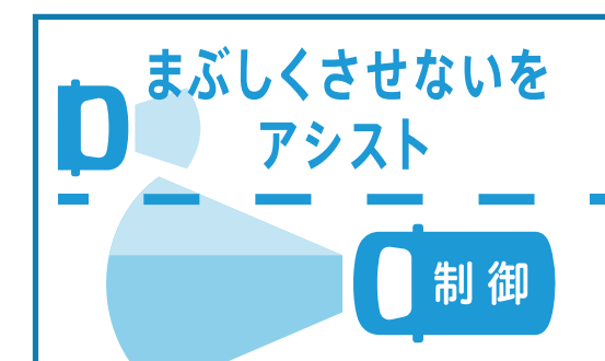
ADB (アダプティブドライビングビーム) 【クルーズターボ、クルーズ (CVT)、デラックス (CVT) にメーカーオプション】
