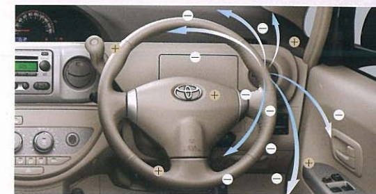
プラズマクラスター® エアコン使用時、送風時にドライバー側の吹き出し口からイオンを放出します。
