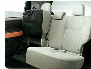
6:4分割可倒式リヤシート (リクライニング、 クッションチップアップ機構付)*3 ●2WD車のみ
