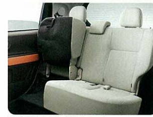
6:4分割可倒式リヤシート (リクライニング、 クッションチップアップ機構付) ●2WD車のみ
