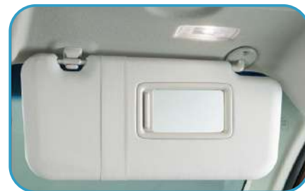
天井照明付サンバイザー (運転席・助手席バニティミラー+ 運転席チケットホルダー付)
