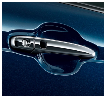
▲ アウトサイドドアハンドル (メッキ加飾) ■ アウトサイドドアハンドルのメイン部のみメッキ 加飾となります(台座はシルバー塗装)。
