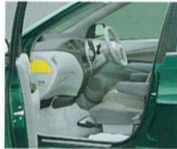
シートロック解除レバーを手前に引いてロックを解除します。[手動]
