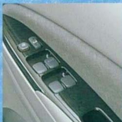
パワーウィンドウ (運転席ワンタッチ式・挟み込み防止機構付) & 木目調スイッチベース(ダークグレー)
