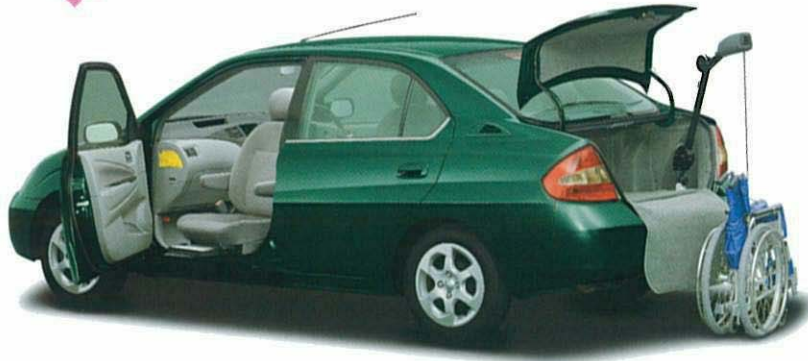
Photo:プリウス G 助手席回転シート仕様 "Bタイプ" (ベース車両はZA-NHW11-AEEGB)。ボディカラーはダークグリーンマイカ(6R4)。※移乗機構付車いすは架装メーカーオプション。
