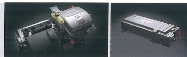
プリウス専用パワーユニット (エンジン、トランスミッション、インバータ)
