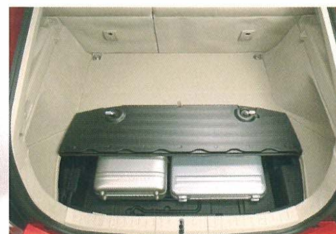
デッキアンダートレイ(デッキボード折りたたみ時)
