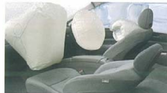
【デュアルステージSRSエアバッグ(運転席・助手席)/SRSサイドエアバッグ&SRSカーテンシールドエアバッグ】
