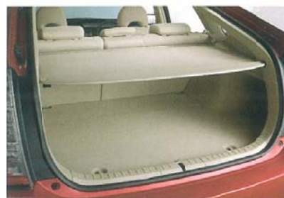
トノカバー ●S*スタンダードパッケージ*以外に標準装備
