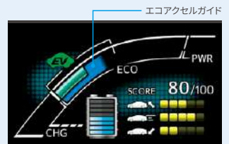
ハイブリッドシステムインジケーター&エコジャッジ
