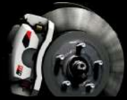
専用ブレーキキャリパー (ホワイト塗装(フロント・リヤ)/ GRロゴ付(フロントのみ))
