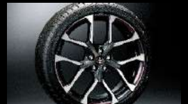
225/40R18タイヤ(ダンロップ SP SPORT 2050) & 18×7½J アルミホイール (ダークグレー塗装+切削光輝 +レーザー照射レッドライン) +専用センターオーナメント ■S*GR SPORTに標準設定。
