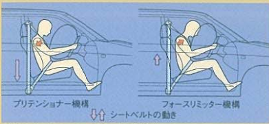
プリテンショナー&フォースリミッター機構付シートベルト
