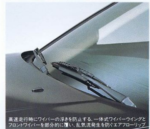
高速走行時にワイパーの浮きを防止する、一体式ワイパーウィンドウとフロントワイパーを部分的に覆い、乱気流発生を防ぐエアフローリップ
