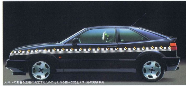
人体への影響を正確に測定するために行われる様々な安全テスト用の実験車両
