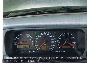
水温/燃料計、マルチファンクションインジケータ ディスプレイ、スピードメーター、タコメーター
