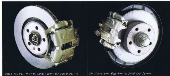
フロント ベンチレーテッドディスク油圧式サーボアシスト付ブレーキ
