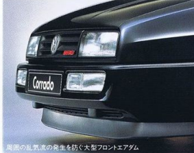
周囲の乱気流の発生を防ぐ大型フロントエアダム
