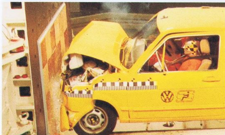
人体への影響を正確に測定するために、実際の事故と同様の状況を設定して行われる衝突実験
