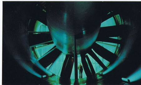
9mのプロペラが作る風は最大風速40m
