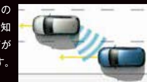
※作動速度範囲 1~12km/h 後退時
