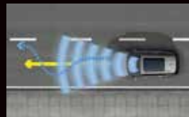
*ステアリングの補正はドライバーのステアリング操作で解除することが出来ます。 ※作動速度範囲 65km/h以上
