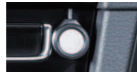
センターパネルに配置されたカメラ画像切替スイッチ
