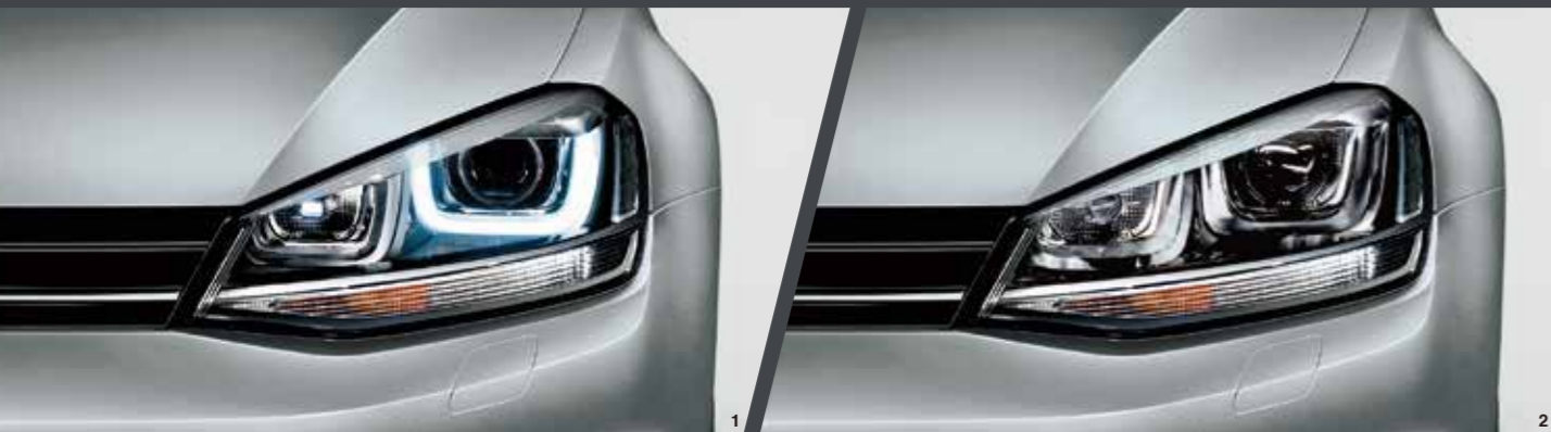
① バイキセノンヘッドライト(オートハイトコントロール機能、LEDポジションランプ付) (T● Highline Connect)
