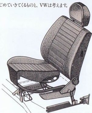
鋼鉄のブリッジによる3点式シートマウント
