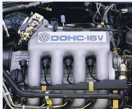
KEジェロニッ プ フュエルインジェクション付のDOHC16バルブガソリンエンジン (GT 16V)
