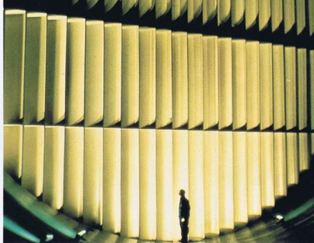
-30℃から45℃まであらゆる気象条件をつくりだせる風洞実験室
