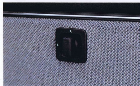
無接入力電動リモートコントロールドアミラー スイッチ。
