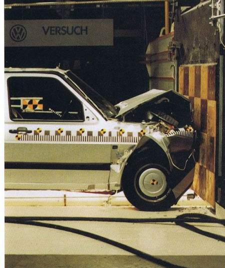
時速50kmで固定壁に衝突させ、ボディの衝撃吸収、変形、人が乗るスペースへの影響を調べるクラッシュテスト。
