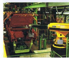
ロボットによるバッテリーの取り付け。
