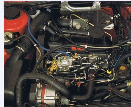
ガソリンエンジンに搭載する低燃費とパワーを持つターボチャージャー付ジーゼルエンジン (GLD turbo)。
