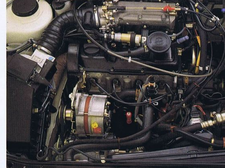
電子制御式燃料噴射装置付デジファントエンジン (GLi)。
