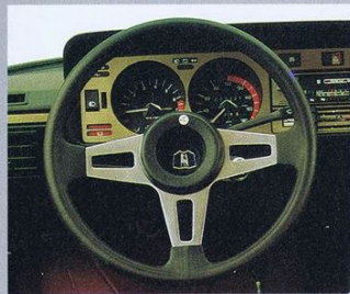
セフティパッド付ステアリングホイール ホイール中央にソフトな感触のセフティパッドを備え、万一の時にドライバーをショックから守ります。
