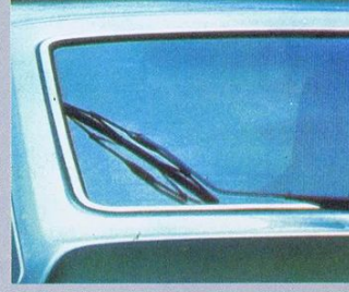
リヤウインドーワイパー 独特のカーブを持つワイパーアームにより、リヤウインドーワイパーは、大きな拭払面積を確保します。
