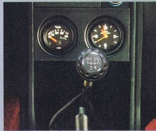
センターコンソール 油温計と高精度のクォーツクロックが組みこまれています。小物のいれるスペースとしても便利です。
