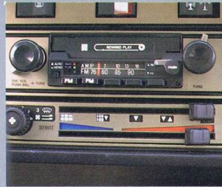
4スピードエアコンディショナー フォルクスワーゲン社純正のエアコンを標準装備。雨の日などには除湿用としても使え、室内さわやか。
