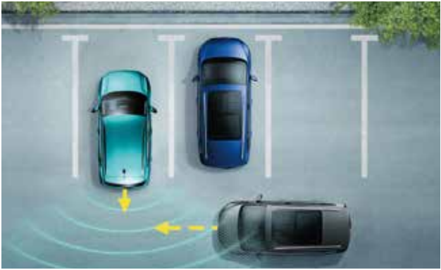
出庫時の後方の安全確認をサポート。 リヤトラフィックアラート (後退時警告・衝突軽減ブレーキ機能)
